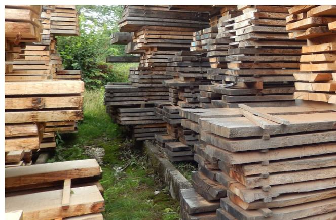
Abb. 7: Um die Rissbildung zu vermindern, wird Eichenholz langsam getrocknet und wird entsprechend dem Einsatzzweck oft Jahre lange gelagert.
